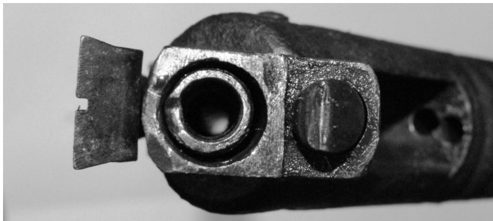
Obr. 4 Podomácky upravená nábojová komora plynovej zbrane Slavia 620 pôvodného kalibru 4,5 mm na vystreľovanie nábojov kalibru 22 Long Rifle.
