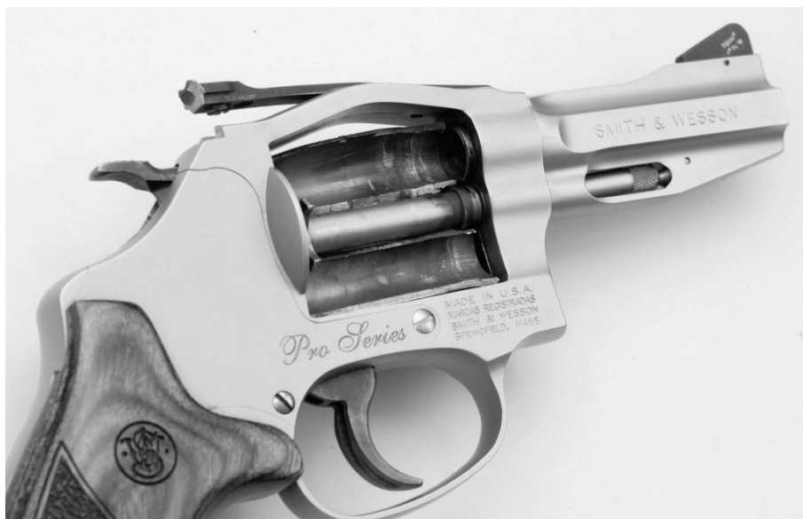
Obr. 6 Deformácia revolvera značky Smith & Wesson, kalibru 357 Magnum, ktorá vznikla vystreľovaním nábojov kalibru 38 Special.
