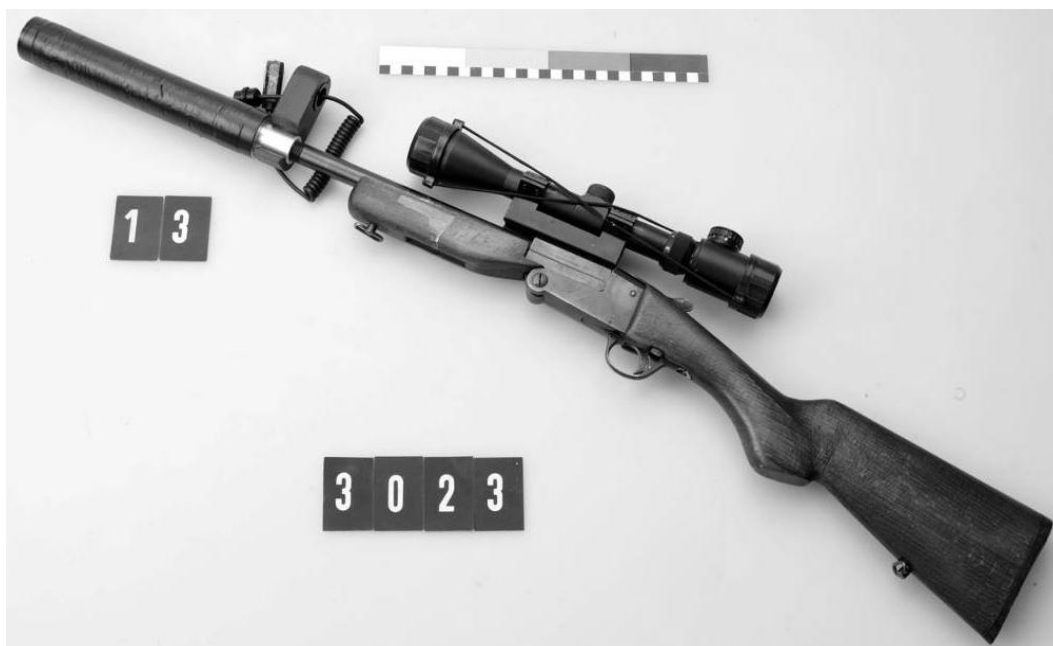
Obr. 1 Podomácky upravená jednovýstrelová brokovnica značky F. PEDRETTI, upravená na kaliber 357 Magnum s tlmičom hluku výstrelu a optickým zariadením.
