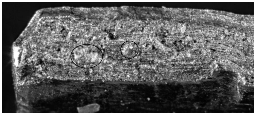
Obr. 3 Makrofotografia lomu valca revolvera kalibru 357 Magnum po používaní nábojov 38 Special (zaujímavosťou sú aj zjavné nečistoty v zliatine – označené v krúžku).
