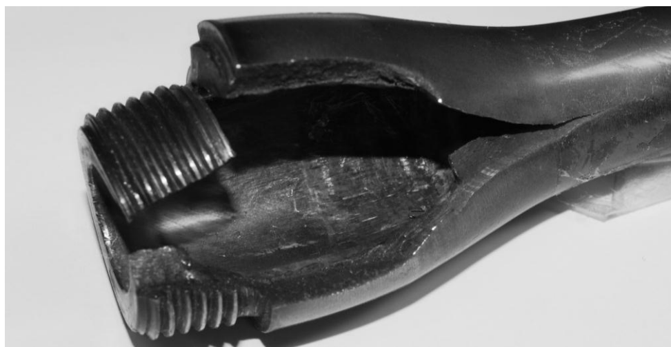
Obr. 7 Deformácia nábojovej komory dlhej guľovej zbrane, značky ZKK 600, kaliber 30-06 Springfield spôsobená podomácky laborovaným nábojom.
