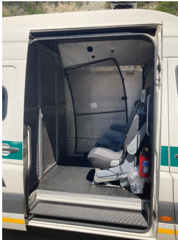
Obr. č. 4 Interiér špeciálneho automobilu (mreža na predné čelné sklo).
